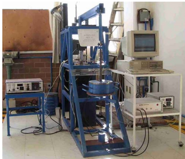
Figura 4.8 Autoclave MEX-02 U2 "Brazo de Palanca", mostrando la instrumentación realizada, como la celda de carga y el lector de la misma, el LVDT para medir desplazamiento .
