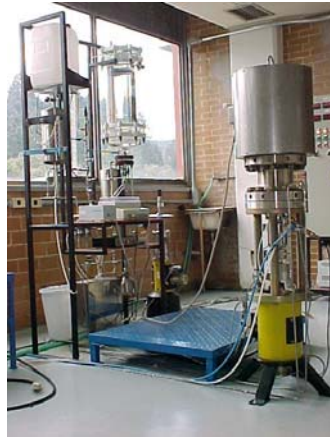
Figura 4.4 Circuito de recirculación y autoclave-máquina de ensayos MEX-01
