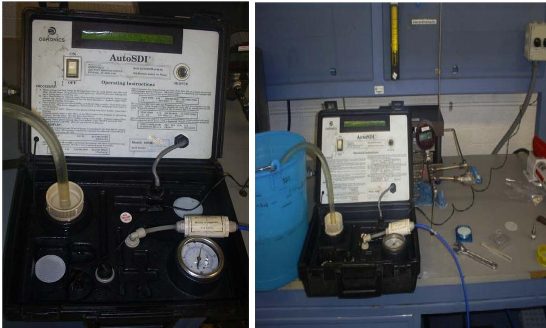
**FIGURA 10. EQUIPO AUTOSDI PARA DETERMINACIÓN DE IDS**
