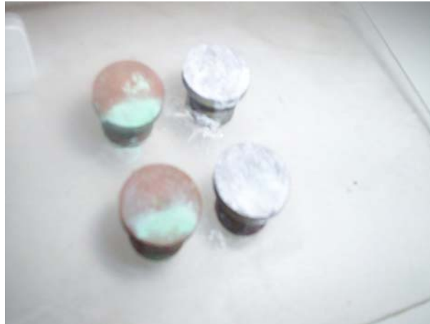
Figura 6.27. Latones con y sin recubrimiento después de 9 días en la cámara de niebla salina.
