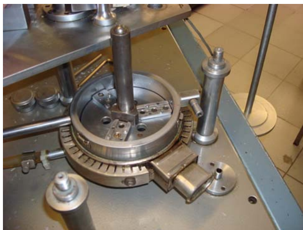
Figura 5.9. Probetas dentro del dispositivo antes de cerrar para iniciar prueba de desgaste.
