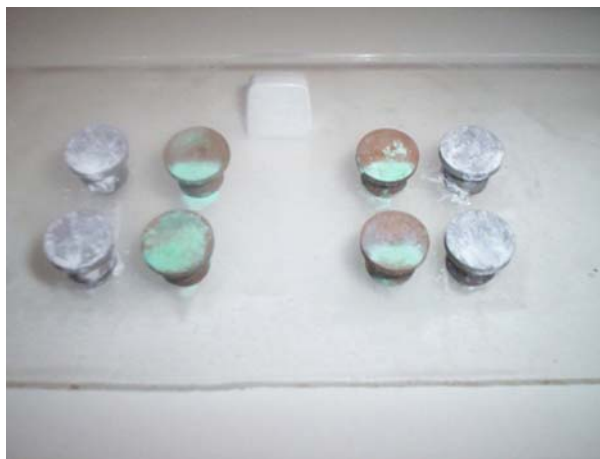
Figura 6.26. Vista de las piezas corroídas al cabo de nueve días de estar las probetas en una solución salina.
