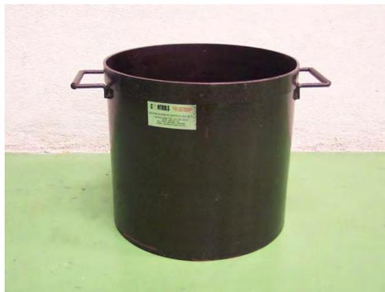
Foto 3.2. Recipiente de volumen conocido para calcular el peso volumétrico suelto y seco.
