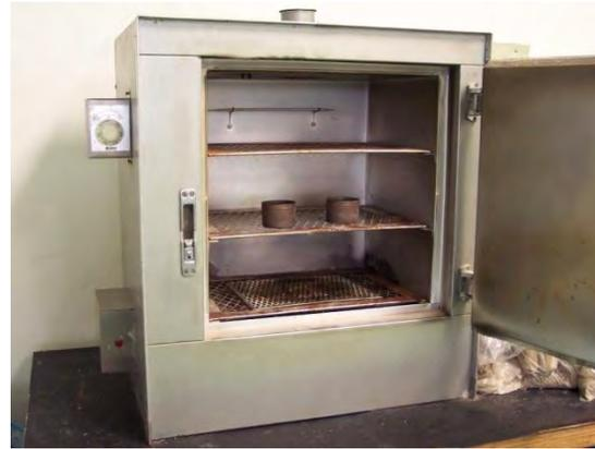
Foto 3.3. Horno de secado con termostato.
