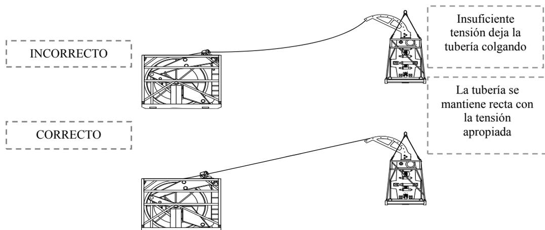
**Figura 2.28. Tensión entre el carrete y el inyector del equipo de T.F.**
