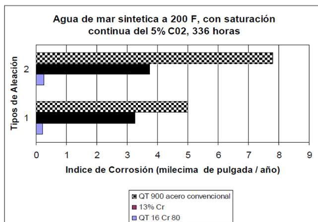
Figura 2.21. Pruebas de corrosión susceptibles a CO<sub>2</sub>.
