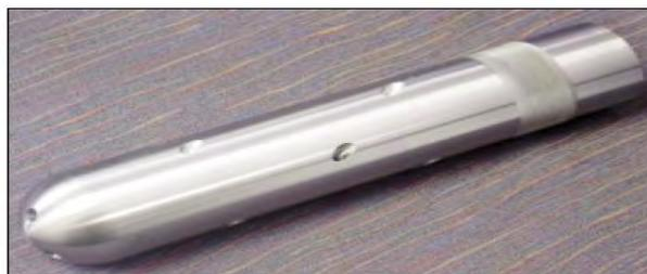
**Figura 5.9.** Servicios de limpieza de pozos, boquilla especial que crea un remolino de fluido utilizando ángulos de chorros para eliminar los sólidos a velocidad.
