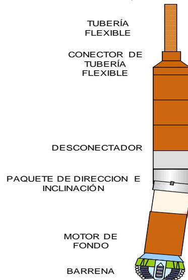
**Figura 3.2. Componentes de la conexión de fondo (BHA), para perforación de pozos direccionales.**
