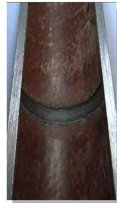
**Figura 4.21. Poder de remoción del Jetting, muestra la eficacia para remover incrustaciones dentro de las tuberías.**
