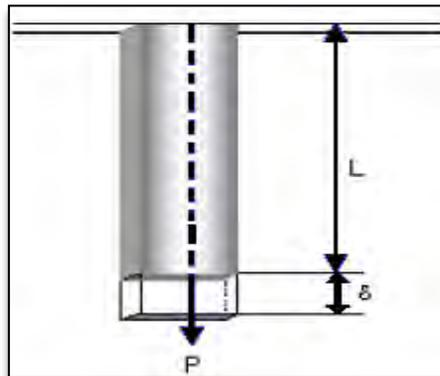
Figura 2.12. Representación de la ley de Hooke,  $\delta \propto \frac{PL}{As}$
