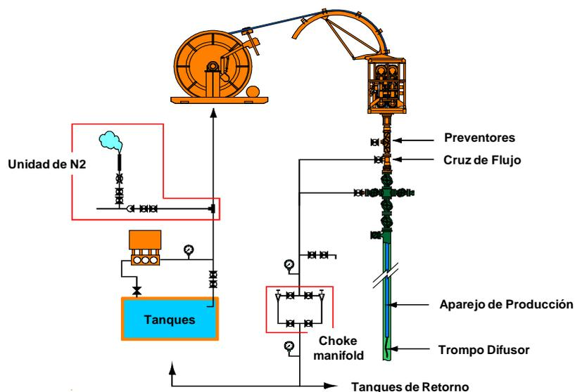
Figura 4.2. Equipo empleado en trabajos de inducción, muestra los componentes que lo integran.
