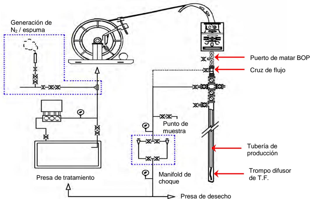
Figura 4.6. Componentes del equipo necesario para limpiezas, muestra los componentes que integran el sistema.
