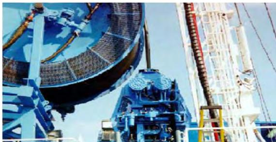
**Figura 2.18. Carrete de diámetro mayor y eliminación de guía para reducir la fatiga en la tubería flexible.**
