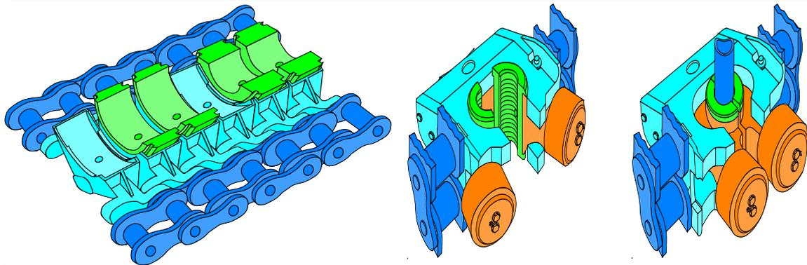
Figura 2.32. Blocks de agarre de la tubería flexible.
