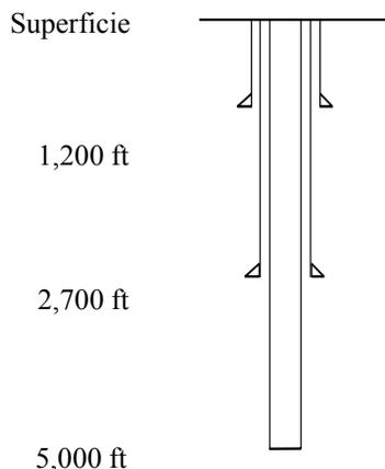
Figura 3.11. Configuración de tubería flexible para aplicaciones en pozos profundos.
