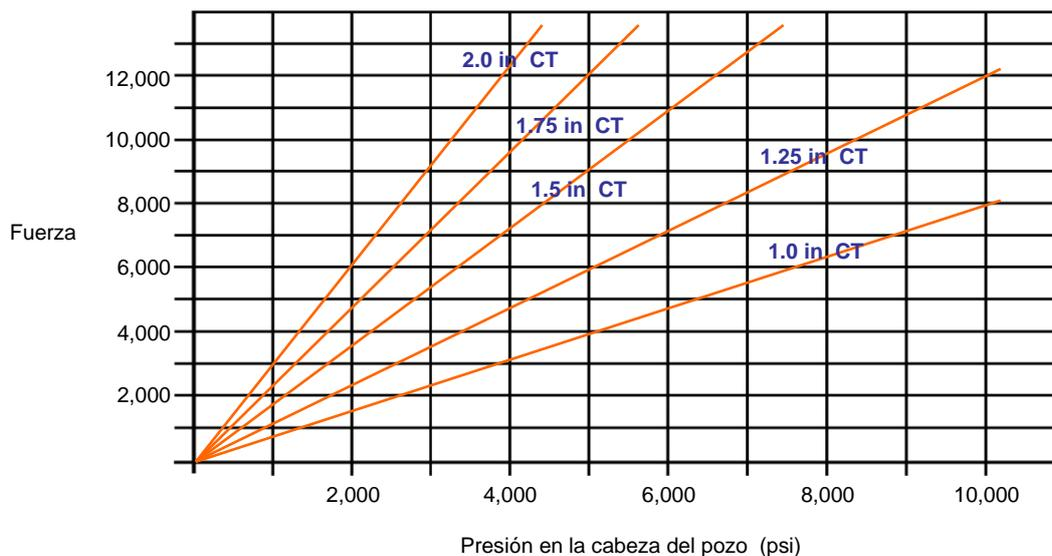
Figura 2.15. Fuerza-Presión para varios diámetros de tubería.
