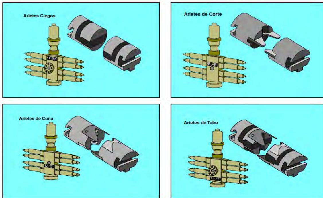
Figura 2.35. Configuración de los arietes, se muestra el arreglo de cada uno de los arietes de acuerdo a sus partes accionadas, para tener un medio de control de las presiones del pozo durante una operación.
