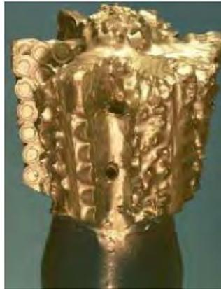
Figura 3.3. Molino para perforar la venta de re-entrada.
