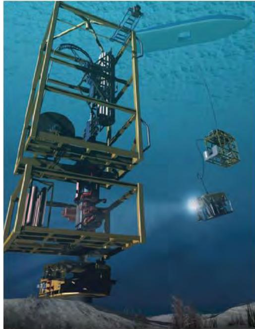
**Figura. 3.13. Equipo de tubería flexible en pozos marinos.**
