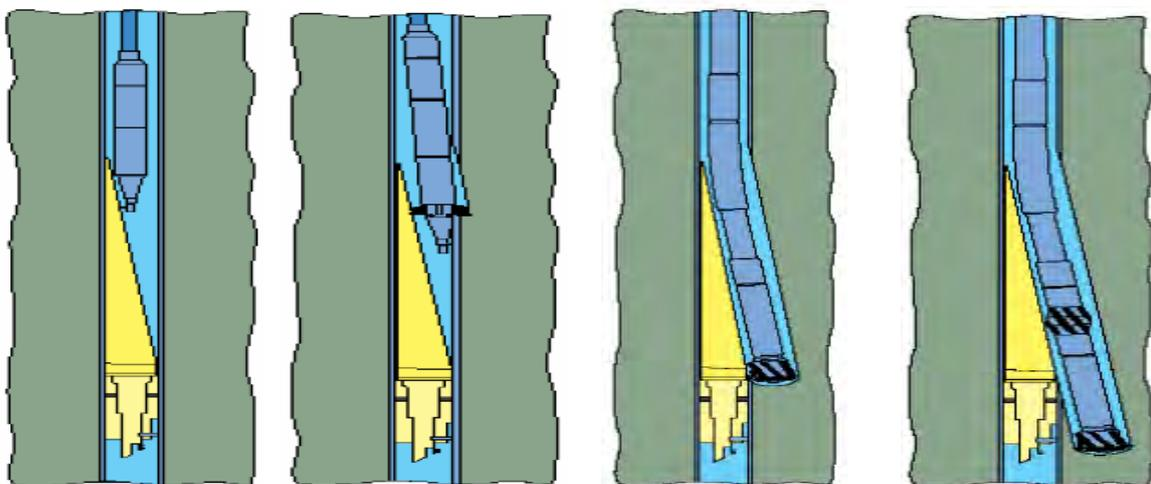
Figura 3.4. De izquierda a derecha: Corriendo y colocando el desviador con una herramienta de posicionamiento (1), comenzando la ventana (2), abriendo la ventana con un molino (3), ampliar y aplanar la ventana con un molino de peso(4).
