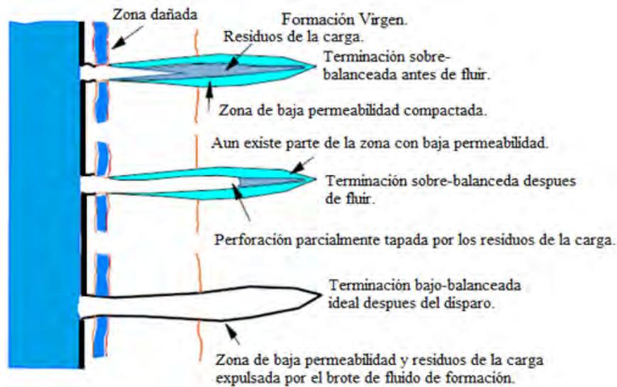
Figura 4.15. Configuración de los disparos de producción, muestra los parámetros presentes bajo cada técnica de terminación.
