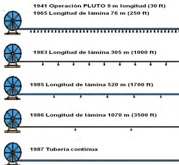
Figura 1.3. Evolución de las sartas de tubería flexible.
