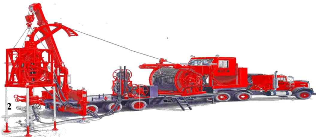
Figura 2.24. Equipo de tubería flexible, muestra cada uno de los componentes del equipo de T.F.
