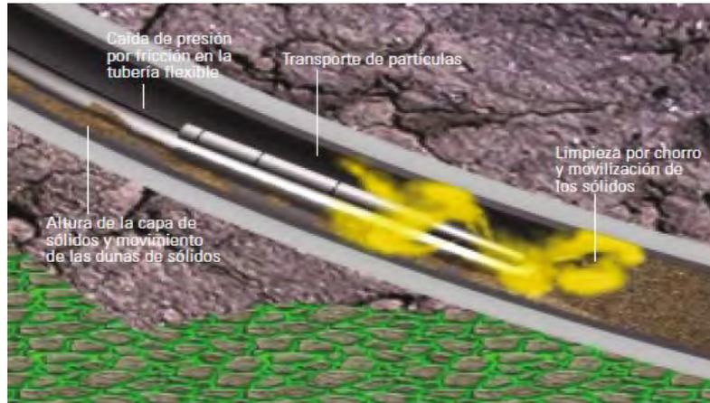
**Figura 5.8.** Limpieza de pozos inclinados y horizontales, durante las operaciones de limpieza de pozos con T.F., el fluido es bombeado por la T.F. a través de una boquilla de fondo de pozo mediante chorros.
