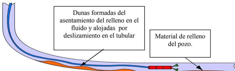
Figura 4.7. Trabajo de limpieza con tubería flexible en pozos desviados, para remover las dunas formadas por asentamiento de partículas y alojadas por deslizamiento tubular.
