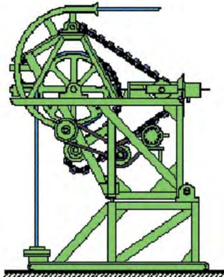
Figura 1.2. Cabeza inyectora Bowen de 1964, como principal componente del equipo de T.F.
