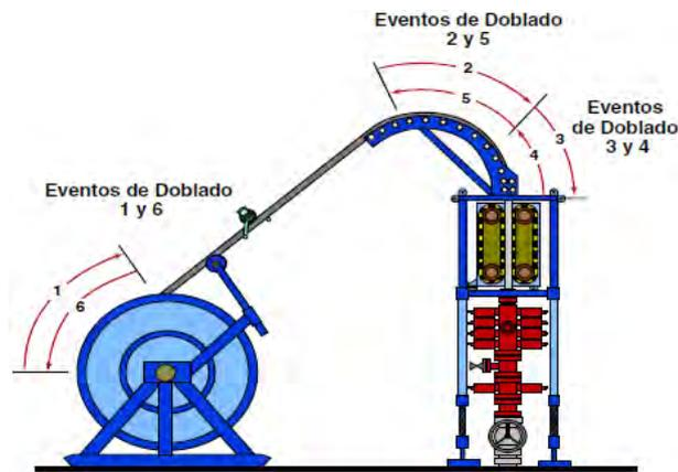
Figura 2.23. Puntos de fatiga en la tubería flexible.
