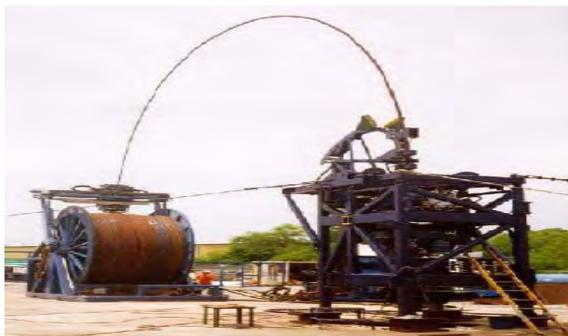
**Figura 2.19. Arco parabólico en la tubería flexible para minimizar el daño por fatiga.**
