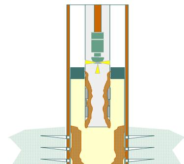
Figura 4.19. Trabajo de Jetting, mediante una boquilla la cual proporciona chorros a alta velocidad.
