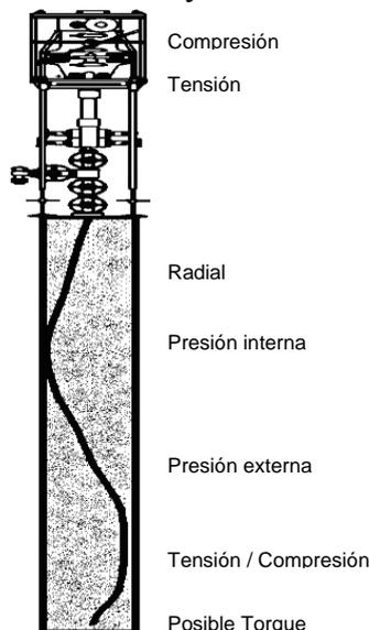
Figura 2.11 Esfuerzos y tensiones aplicados en la tubería flexible.
