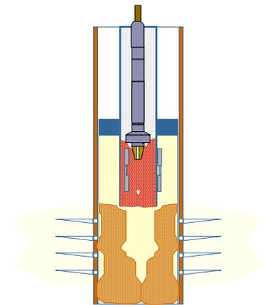
Figura 4.5. Limpieza en pozos para remover asentamiento de sólidos, empleando T.F.
