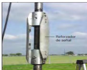
**Figura 5.13. Herramienta de control de la profundidad DepthLOG, la cual ayudo al óptimo posicionamiento del empacador inflable.**
