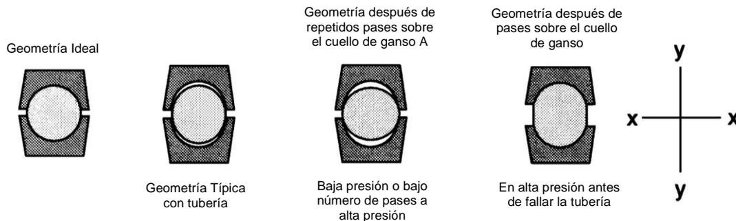
Figura 2.20. Ovalidad en la tubería flexible.
