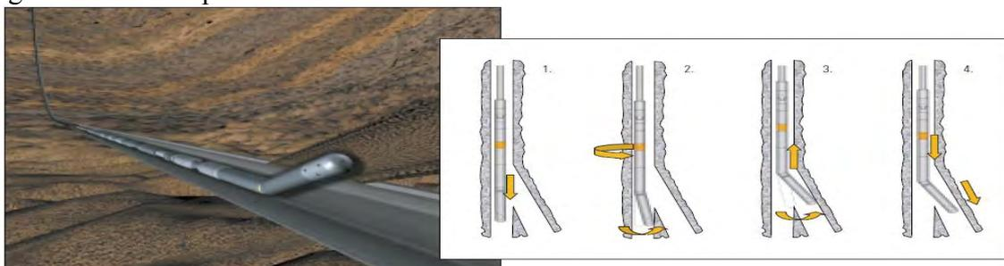
**Figura 5.14. Sistema Discovery MLT incluye un dispositivo de orientación controlable para hacer rotar la herramienta y un empalme acodado ajustable.**
