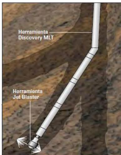
**Figura 5.15. Herramienta multilateral Blaster MLT, permite ingresar a los ramales y realizar un lavado por chorro de alta energía.**
