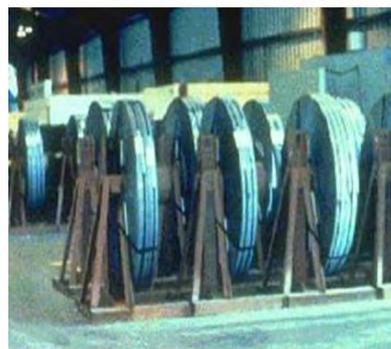
Figura 2.3. Rollos de lámina de acero cortada de acuerdo al diámetro de tubería requerido.
