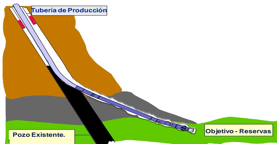
Figura 3.5. Re-entrada en pozos con tubería flexible.
