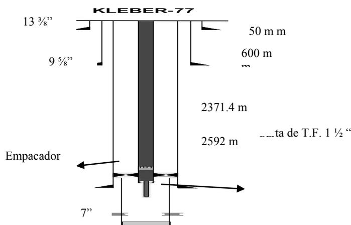
Figura 4.8. Sarga de velocidad con tubería flexible, para mejorar el flujo en la tubería de producción.
