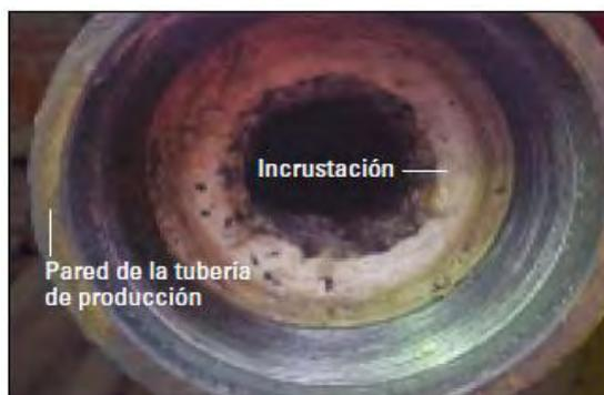
**Figura 5.10. Acumulación de incrustaciones en las tuberías del pozo, las cuales reducen el área de flujo.**
