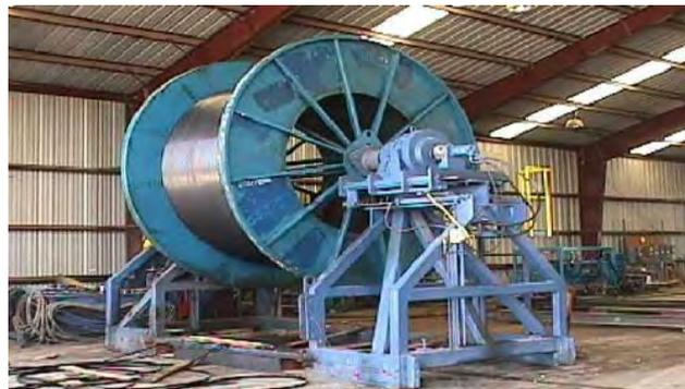
Figura 2.7. Proceso final de fabricación, carrete de tubería flexible.
