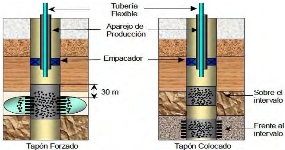
Figura 3.10. Colocación de tapones de cemento con T.F.
