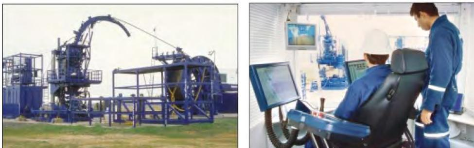
**Figura 5.6. Unidad de T.F. y control del sistema, un sistema instalado en la cabina de la unidad “CT SEAS”, opera el carrete, el cabezal inyector, el equipo de control del pozo, las temblorinas para el lodo y las bombas.**
