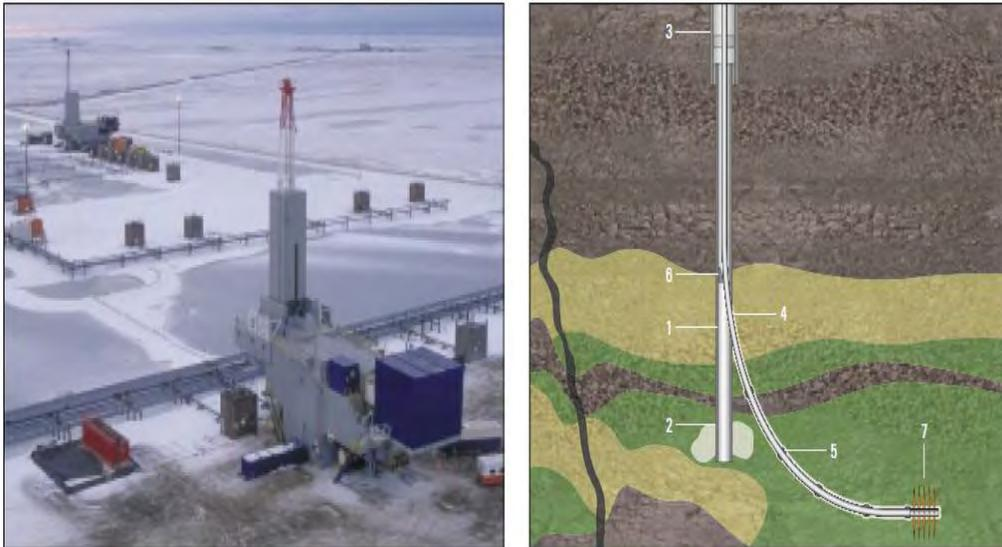
Figura 5.3. Perforación con tubería flexible en el Talud Norte de Alaska, implica la bajada de una cuña desviadora a través de la tubería de producción y su asentamiento a la profundidad de desviación en la tubería de revestimiento.
