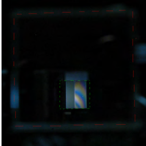
Figura IV.13: Interferencia de luz blanca observada en el interferómetro. El recuadro rojo señala el divisor de haz por el cual se observa, y el recuadro verde señala el divisor de haz guía.
