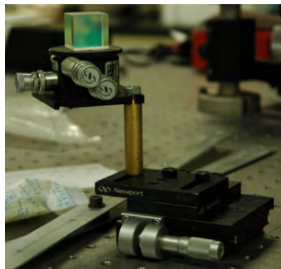
Figura IV.7: Montura utilizada para acomodar el divisor de haz guía.
