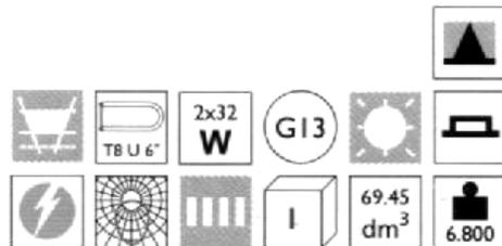
Conexión / Connection: 127 V±10%, 60 Hz
