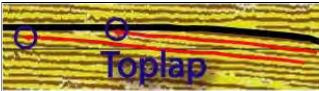
Figura 4.4 Imagen que muestra el límite superior de una secuencia y que corresponde con un Toplap ( http://strata.geol.sc.edu/ ).
