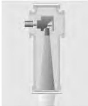
*Figura 3.21.* Módulo constructivo para empalme de la celda a cables de alto voltaje de acuerdo a las normas de la IEC (International Electrotechnical Commission). La construcción estandarizada de los módulos permite la conexión de varias secciones y diferentes tipos de aislamientos. La conexión de cables paralelos para conducir altos rangos de corrientes también es posible usando el mismo modulo
