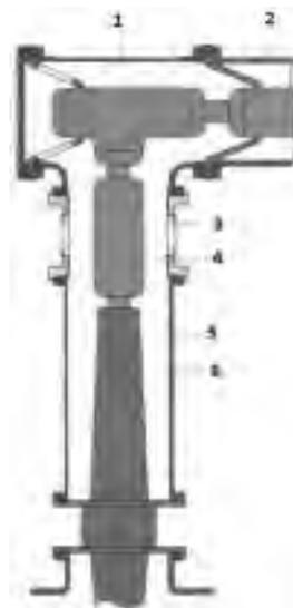
*Figura 3.24.* Módulo constructivo de conexión a transformador/autotransformador/reactor con aislador gas/aceite. (1) Módulo de conexión, (2) Módulo de prolongación, (3) Fuelle compensador, (4) Barra conductora de conexión, (5) Envoltura, (6) Aislador pasante gas/aceite.
