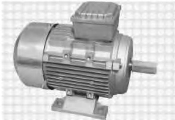
*Figura 4.3. Cargas del tipo inductivas*
