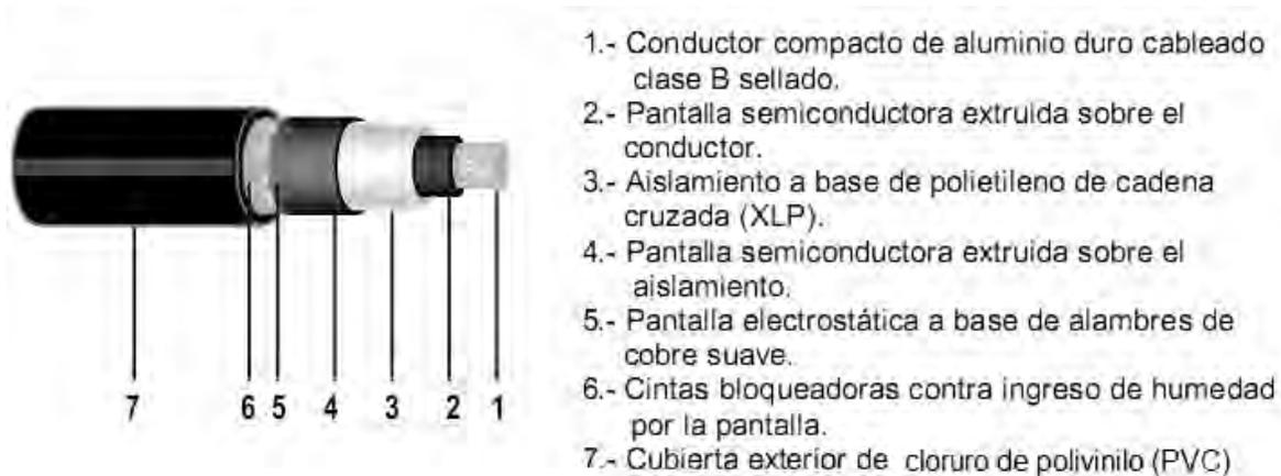
Figura 2.17. Aplicación del polietileno de cadena cruzada (XLP) y del cloruro de polivinilo (PVC) en la fabricación de cables de alto voltaje.
