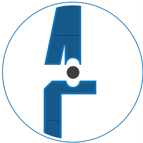
Detalle de como se sella la carcasa mediante un empaque dispuesto en un dos carriles
