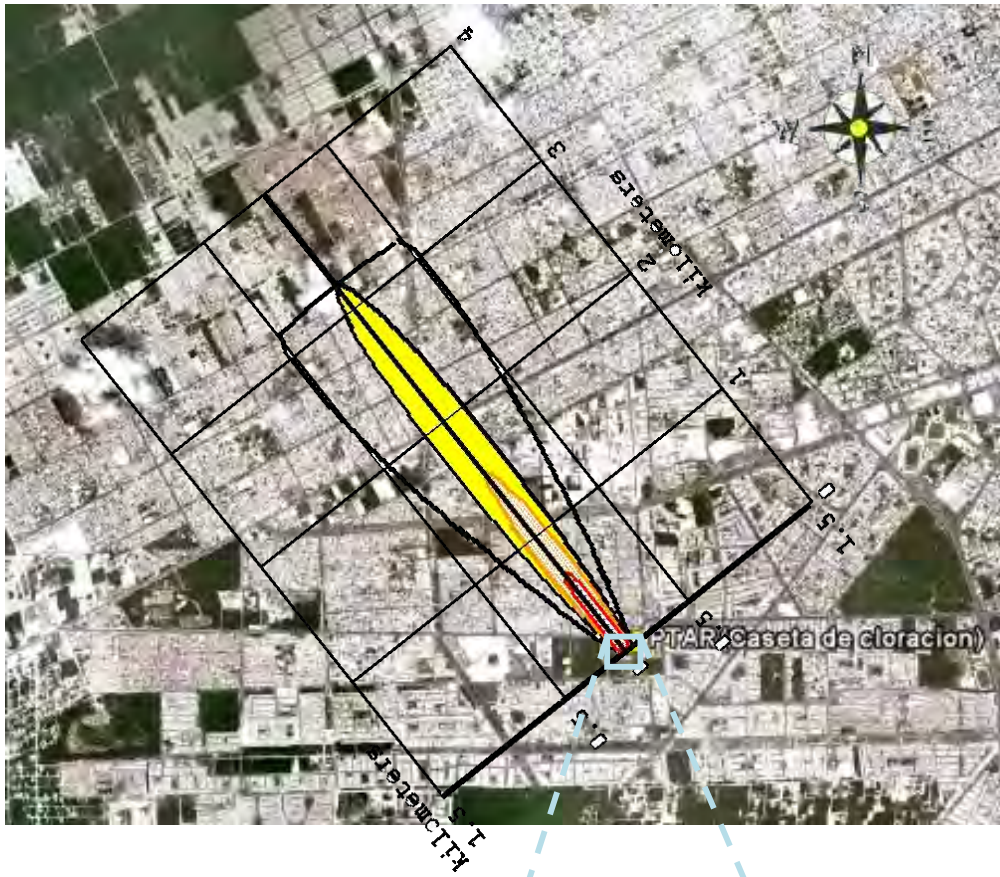
Imagen 6. Vista de la zona afectada por concentración de cloro. Vientos del Sureste.
