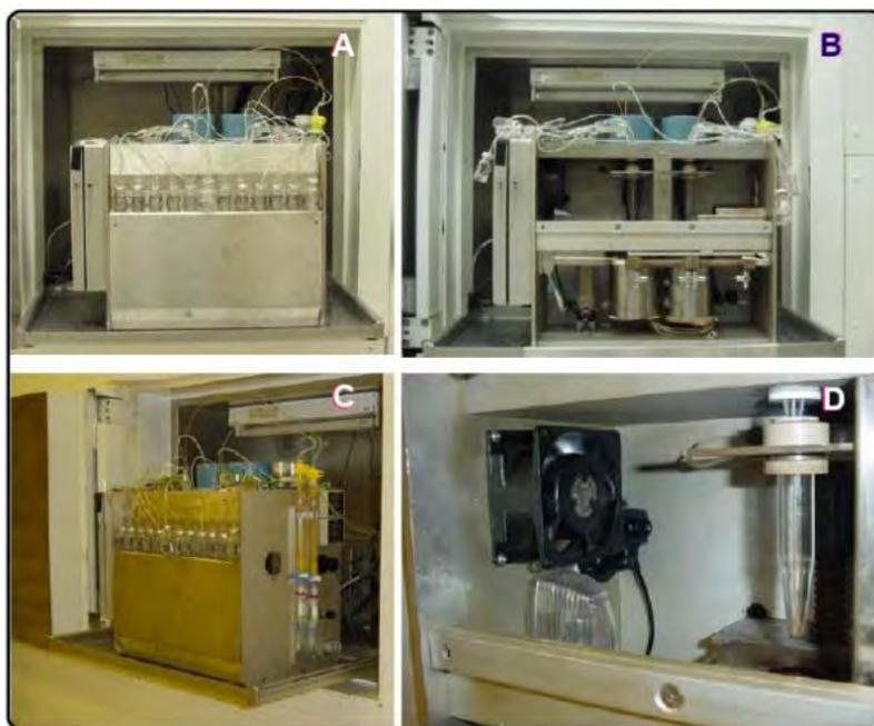
Figura 4.3. Módulo CPCU, A) vista externa (arreglo de viales), B) vista interna (baños de aceite), C) vista lateral (conexiones) y D) se muestra un vaso de reacción.
