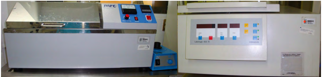
Figura 20. Baño con agitación y control de temperatura, vórtex y centrífuga con refrigeración. (Fuente directa).
