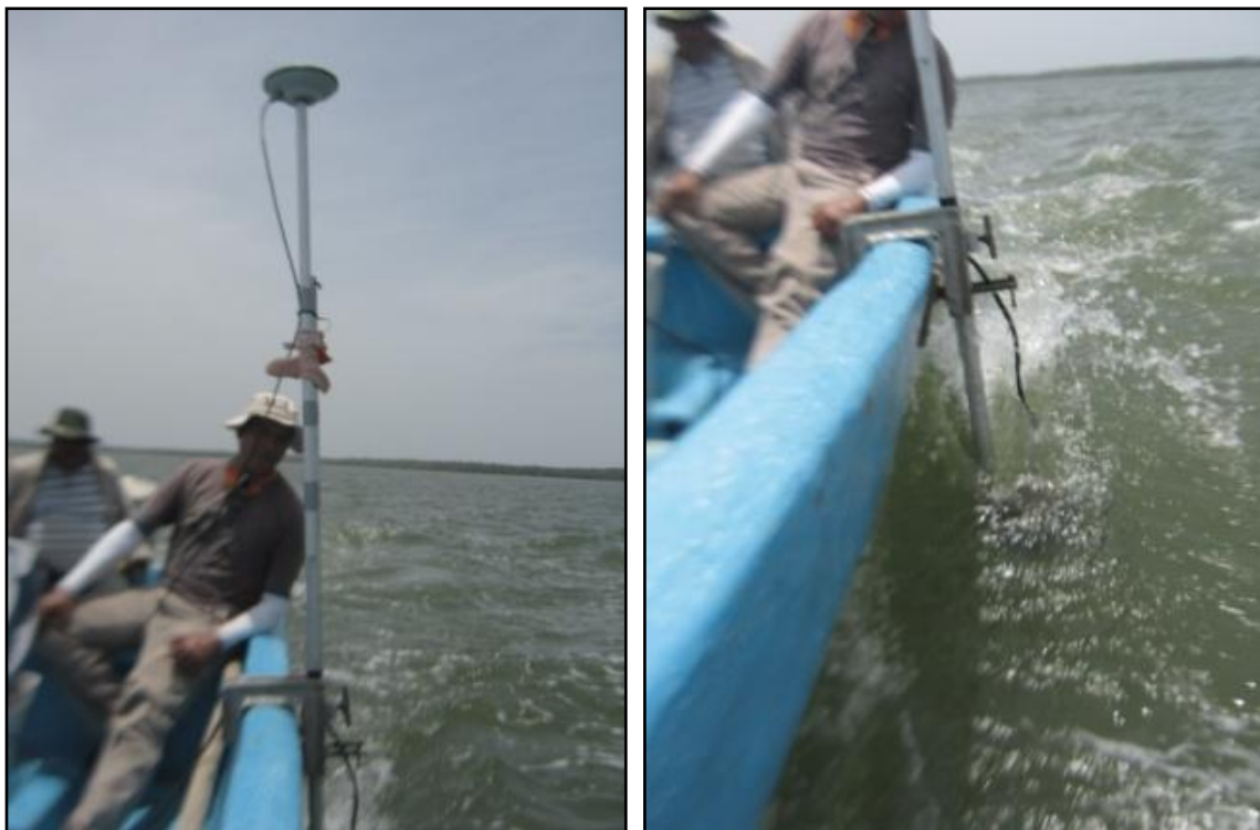
Figura 1.4 Panel izquierdo: antena GPS diferencial. Panel derecho: Sonar sumergido
