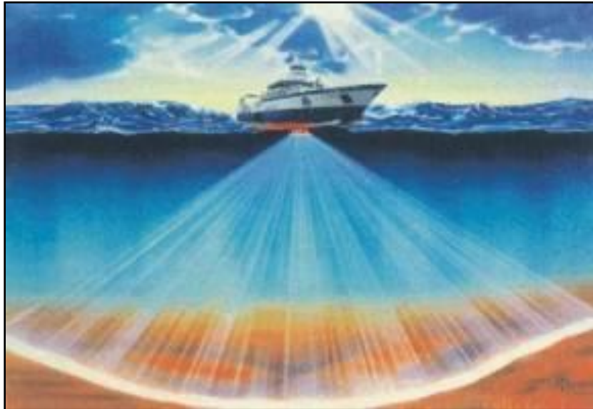
Figura 1.2 Funcionamiento de la ecosonda para detectar el fondo marino
