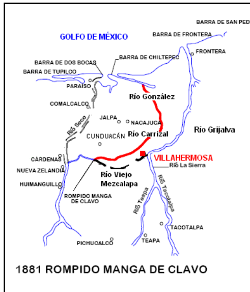
Figura 1.11 El rompido de Manga de Clavo originó el nacimiento del río Carrizal, que en su parte final se conoce como río González (Velázquez G.V., 1994)
