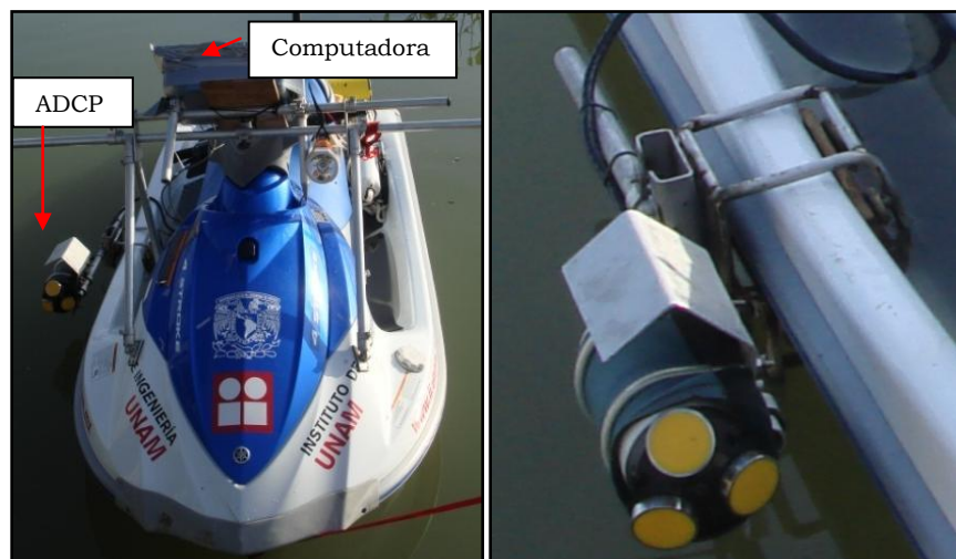
Figura 1.8 En la moto acuática se instalaron un ADCP, CTD y una computadora en la realización de transectos (panel izquierdo). Acercamiento del ADCP (panel derecho)
