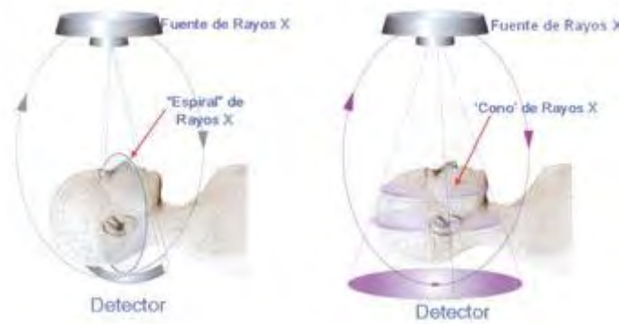
Fig. 20. Esquema que muestra la adquisición de la imagen en la Tomografía Computarizada (izquierda) y en el New Tom Cone Beam 3D (derecha). 11
