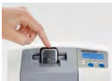
Fig. 15. El sensor es introducido para el escaneo en el Vista Scan. 10
