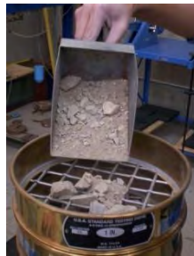
Figura 3.45 Vaciado del material en los tamices.
