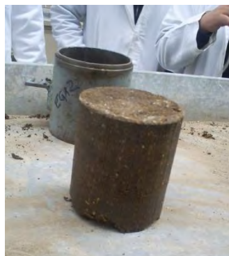
Figura 4.54 Muestra de suelo compactada.
