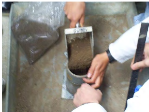
Figura 4.51 Colocación de la capa de suelo.
