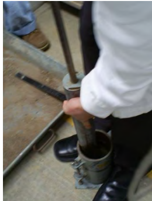
Figura 4.52 Compactación de la capa de suelo.
