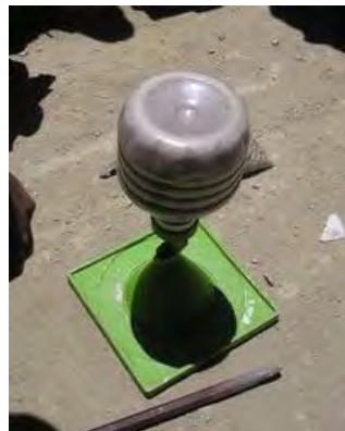
Figura 4.61 Colocación del cono (ingenieracivil.blogspot.com).
