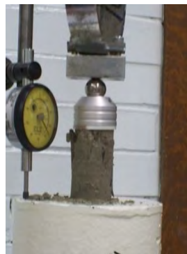
Figura 4.28 Toma de lecturas de tiempo, deformación y carga.
