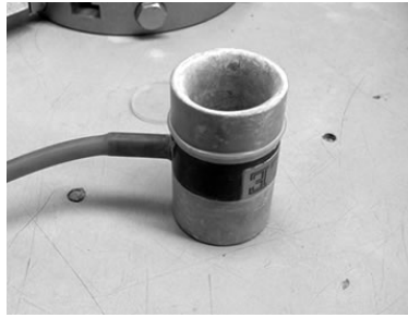
Figura 4.37 Colocación de la membrana en el cilindro.
