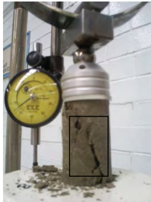
Figura 4.29 Falla de la probeta de suelo.
