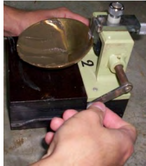
Figura 3.32 Giro uniforme de la manivela a razón de dos golpes por segundo.
