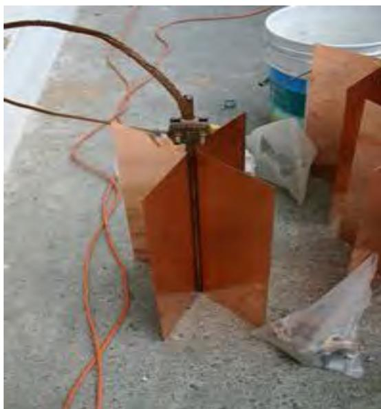
Figura 3.11 Electrodo de puesta a tierra tipo rehilete.
