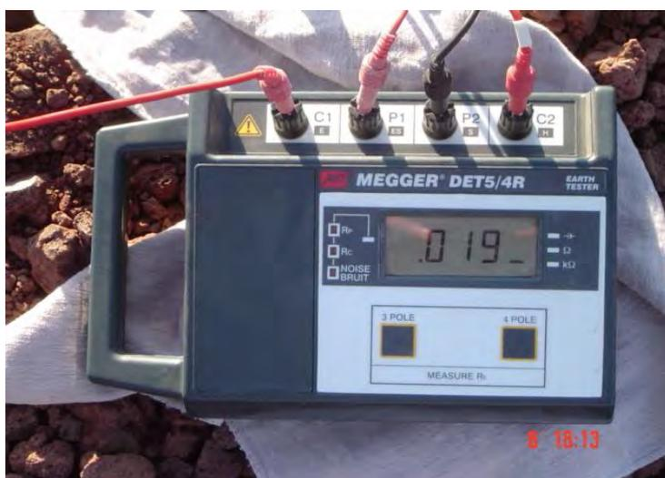
Figura 3.5 Lectura tomada en un área determinada con una separación de 8.00 m y profundidad de 0.30 m.
