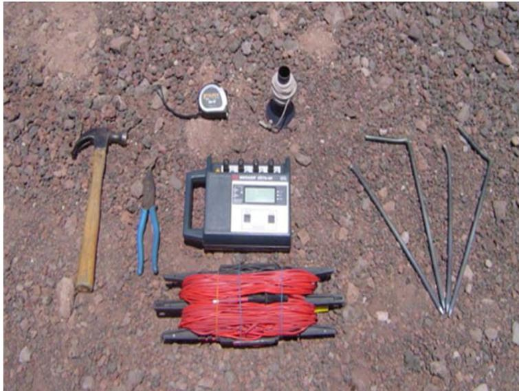
Figura 3.2 Equipo de medición de resistividad del terreno.
