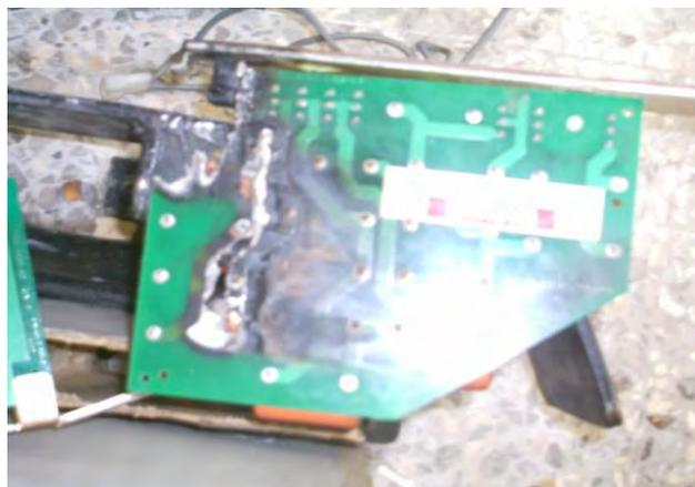
Figura 5.13 Pérdida total de una tarjeta electrónica.
