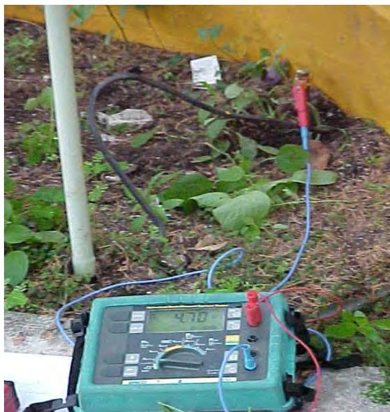
Figura 3.12 Medición de un electrodo de puesta a tierra.
