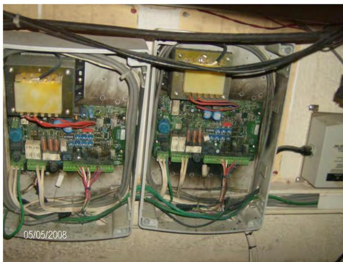
Figura 5.14 Daño irreparable a tarjeta electrónica.
