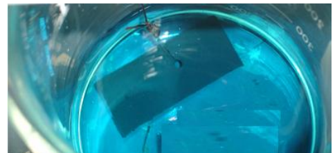
Paso No. 6: Sumergir la pieza en el sulfato de cobre.
