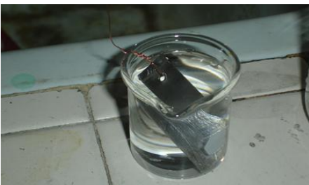
Paso No. 5: Limpieza de la pieza en acetona.
