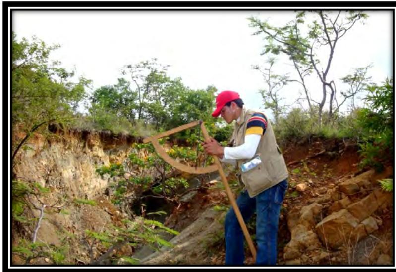
Figura 1.1. Medición de la columna estratigráfica usando el báculo de Jacob y cinta métrica.
