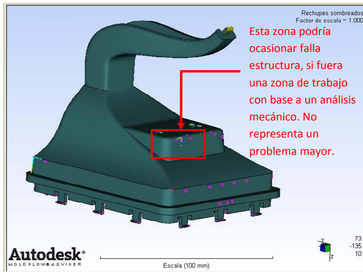
Figura 54. Zonas de localización de zona de posible falla mecánica.
