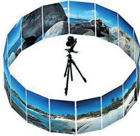
Figura 26. Esquema para realizar las tomas para producir un panorama 360°
