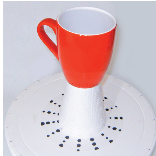
Figura 40. Modelo original con patrón de puntos sobre la base giratoria para una óptima interpretación del espacio.
