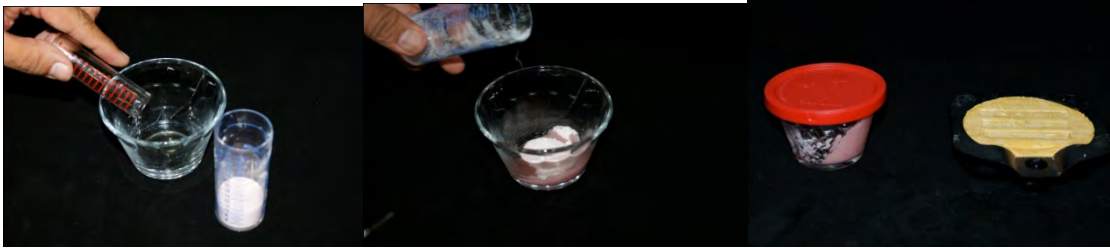
19a Verter líquido monómero 19b Adición de polvo polímero 19c Reposo por 3.5 min.
