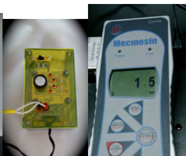
25c Interruptor 25d Celda de carga AFTI
