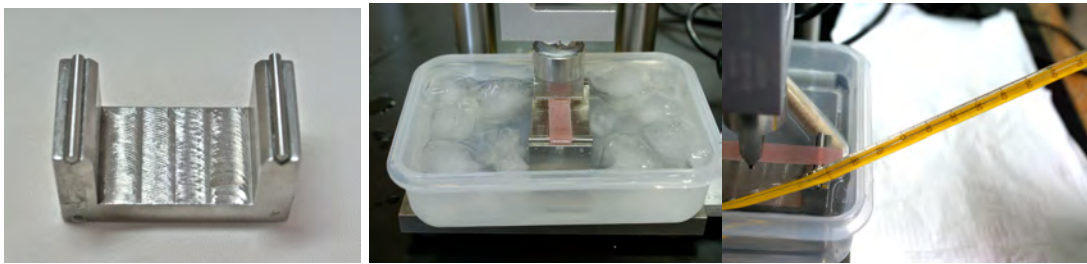
26a soporte de las muestras 26b Inmersión de muestra en agua 26c Lectura de temperatura
