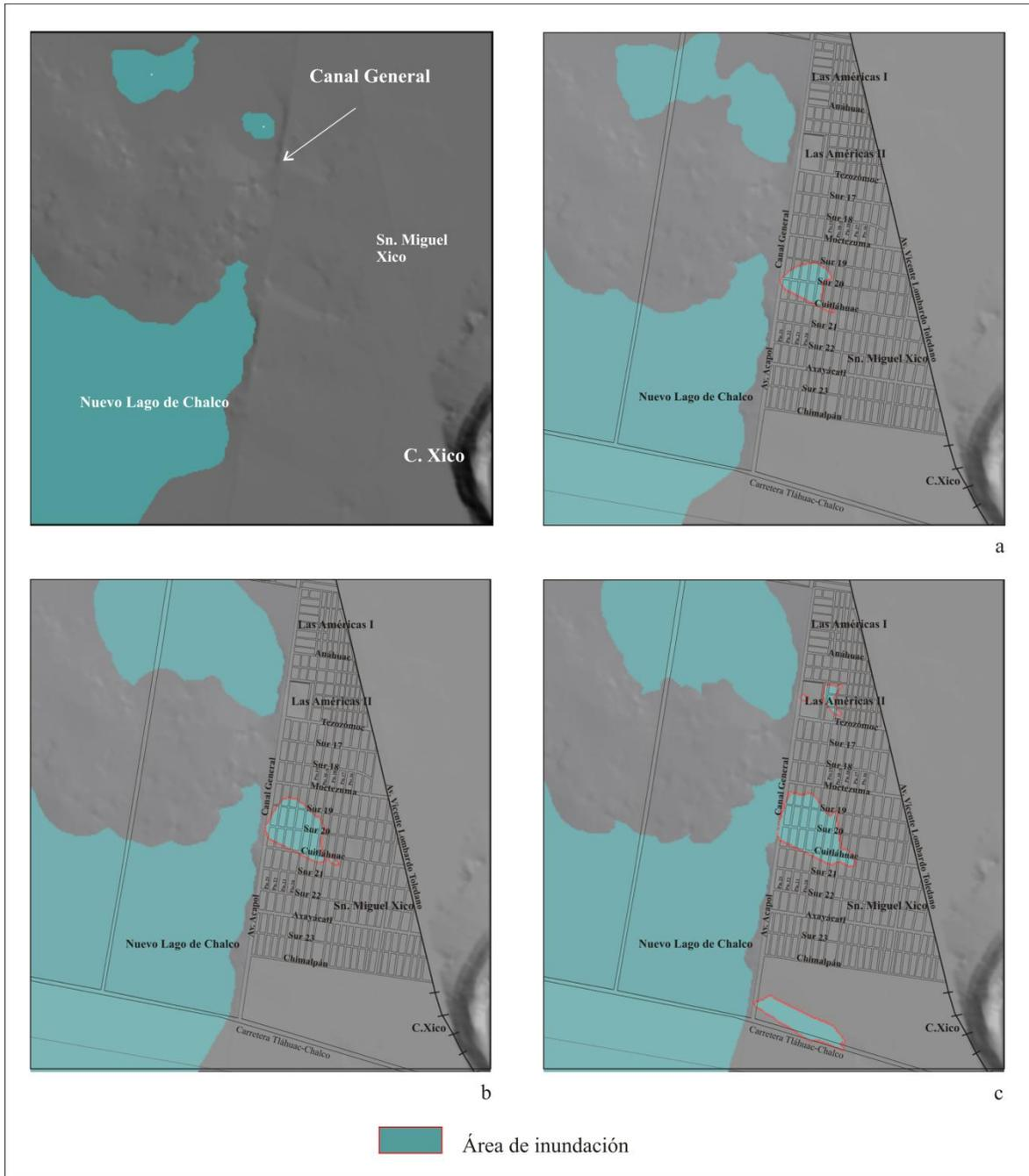
**Figura V. 7.** Resultados del algoritmo *Water\_filling* con una lámina total de a) 2226, b) 2226.50 y c) 2226.80 msnm.
