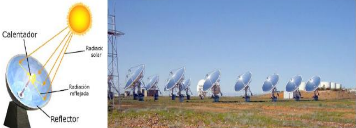
Figura 1.41.- Captadores de discos parabólicos 38
