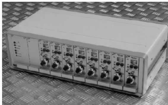
Figura C.6: Consola para 8 monitores de las sondas de onda
