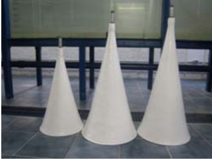
Figura VI.10: Blow-Jet 1, 2 y 3 en fibra de vidrio
