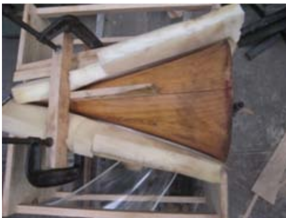
Figura VI.8: Enfriamiento del acrílico en contacto con el molde de madera
