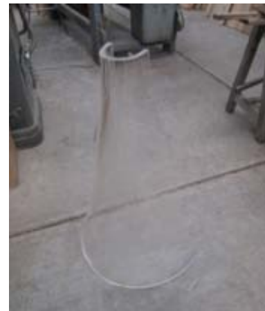
Figura VI.9: Mitad del Blow-Jet en acrílico
