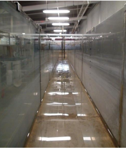
Figura 10. Interior del canal de olas
