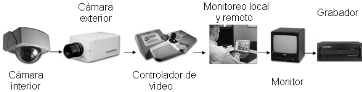
Figura 4.4.- Sistema de CCTV.
