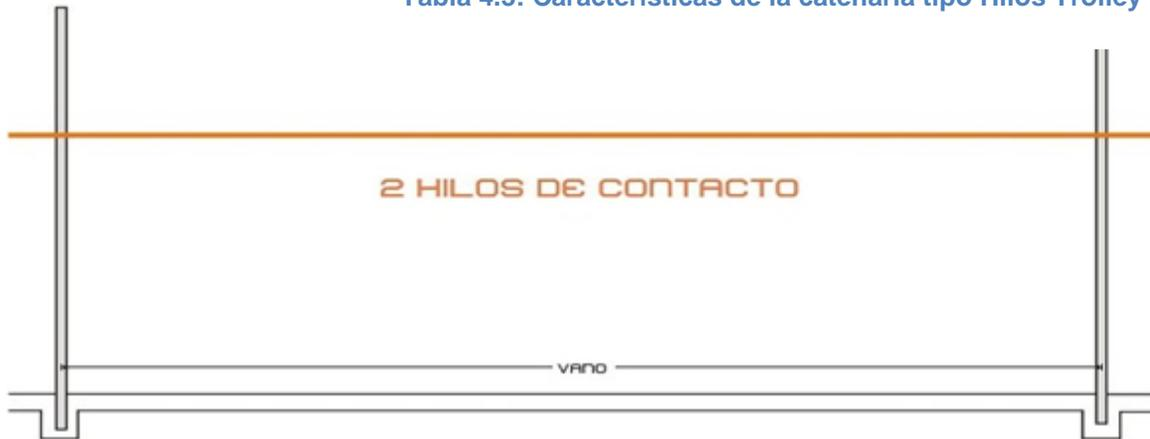
Figura 4.37: Catenaria Hilos Trolley
