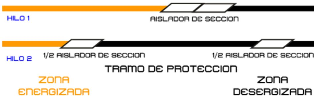
Figura 4.20: Vista superior de los hilos de contacto en tramo de protección
