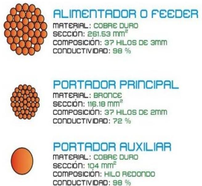
Figura 4.33: Tipos de sección transversal del cable para alimentación eléctrica el cual se utiliza
