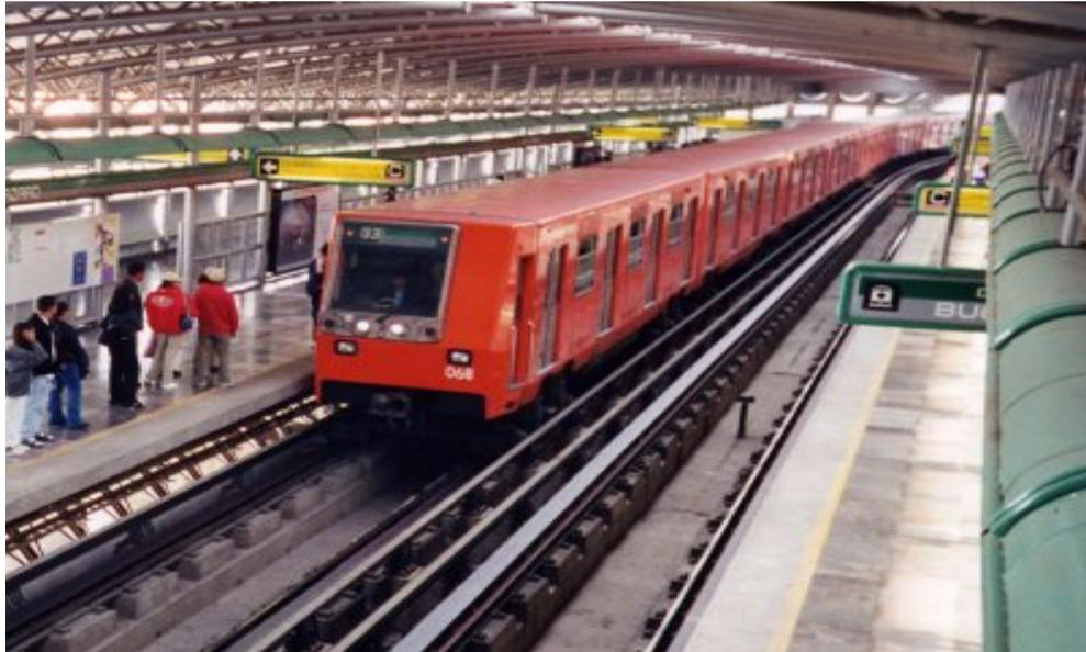
Figura 4.2: Metro con rodadura neumática
