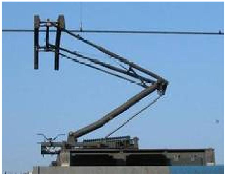
Figura 4.6: Pantógrafo tomando corriente por medio de catenaria
