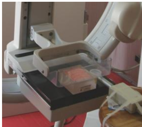
Figura 4.5 Reproducibilidad del control automático de exposición; se observa el maniquí de prueba y la cámara de ionización.
