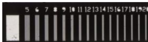
Figura 3.3 Patrón de barras de 5 a 20 pares de línea por milímetro.
