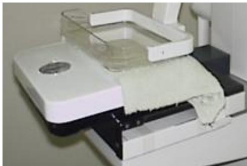
Figura 4.6 Fuerza de compresión, se muestra la colocación de la báscula sobre el portachasis.
