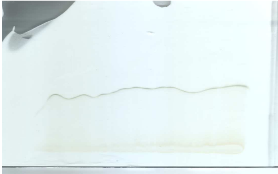
Figura 9. Se realizó la separación cromatográfica en capa fina de sílica gel G60 con mezcla de eluyentes cloroformo-metanol 9:1 y se observó la fracción mostrada que al parecer corresponde a la clorofila con un valor de Rf de 0.45.
