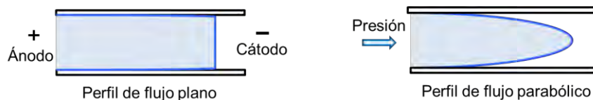
Fig. 7. Comparación del perfil de flujo electroosmótico e hidrodinámico.
