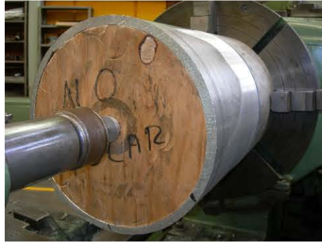
Figura 5.8: Ésta es la sección de tubo que se utilizó para construir la lata, se puede observar montado en el torno del taller pues fue necesario rectificarlo y disminuir su espesor a aproximadamente 5 mm.
