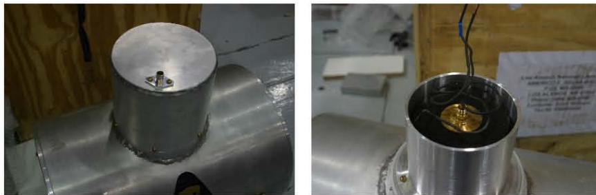
Figura 5.10: Aquí se pueden ver las dos tapas de la lata ya perforadas además de que en una ya se encuentra montada la membrana de 0.5 mm, la cual es perpendicular al eje de propagación del haz de neutrones.
