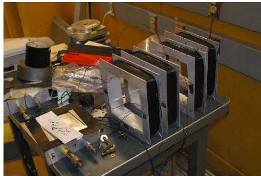
Figura 5.16: Bobinas cuadradas con una capa de cinta de aislar en la superficie.
