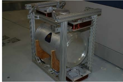
Figura 5.30: Inversor de Espín montado en la estructura de aluminio antes de ser colocado en el experimento.
