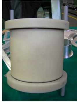
Figura 5.12: Carrete de nylon para el solenoide. Las tapas se fijaron con tornillos de plástico, al igual que las “patitas” de los extremos del carrete, las cuales tienen cuerda.
