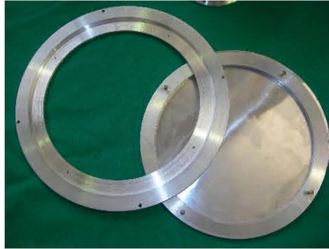
Figura 5.10: Aquí se pueden ver las dos tapas de la lata ya perforadas además de que en una ya se encuentra montada la membrana de 0.5 mm, la cual es perpendicular al eje de propagación del haz de neutrones.
