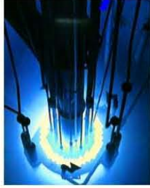
Figura 2.5: Radiación Cherenkov producida durante el funcionamiento de un reactor nuclear. Tomada de [14]
