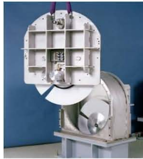
Figura 2.8: Dentro de este armazón se encuentran las paletas, o discos, los cuales dejarán pasar a los neutrones dependiendo su longitud de onda. Tomada de [23].
