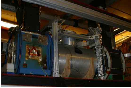
Figura 2.13: Celda montada en la línea del haz dentro del horno (caja azul, lado izquierdo de la fotografía). La luz láser llega a la celda a través del tubo de sección rectangular negro en la parte de arriba.
