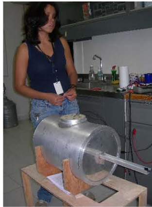
Figura 5.23: El solenoide se encuentra dentro de la lata. Se pueden apreciar las membranas perforadas y el canal que se utilizó para llevar a cabo el mapeo del campo.
