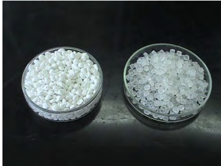
Figura 5 Comparación entre las partículas obtenidas en el laboratorio (lado izquierdo) y las obtenidas industrialmente (lado derecho)
