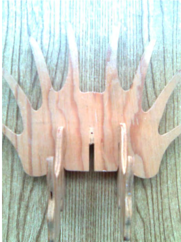
Figura 3.- Superficies de madera pegadas con el adhesivo en base acetato de etilo- acetona – poliestireno
