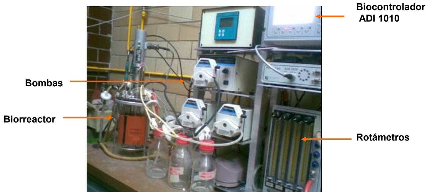
Figura A.11.1. Biorreactor automatizado Applikon.
