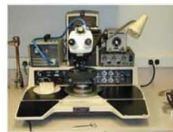
ESTACIÓN DE ALAMBRADO.
