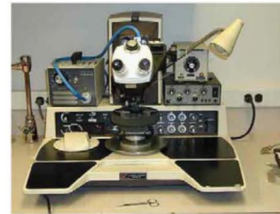
ESTACIÓN DE ALAMBRADO.
