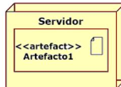
Figura 2.34 Diagrama de un artefacto en UML.
