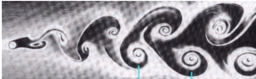
Figura 4. El esquema muestra la trayectoria de los vórtices denominados camino de Von Kármán.
