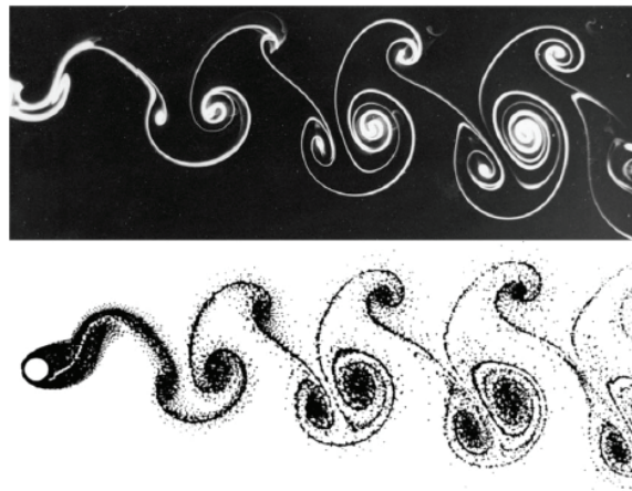
Figura 8. Modo 2P, comprende dos pares de vórtices formados cada uno por el movimiento de la sección.
