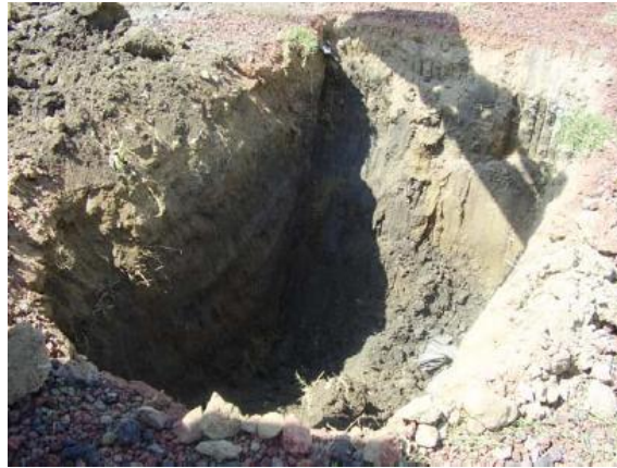
Figura XI Pozo a cielo abierto (PCA)
