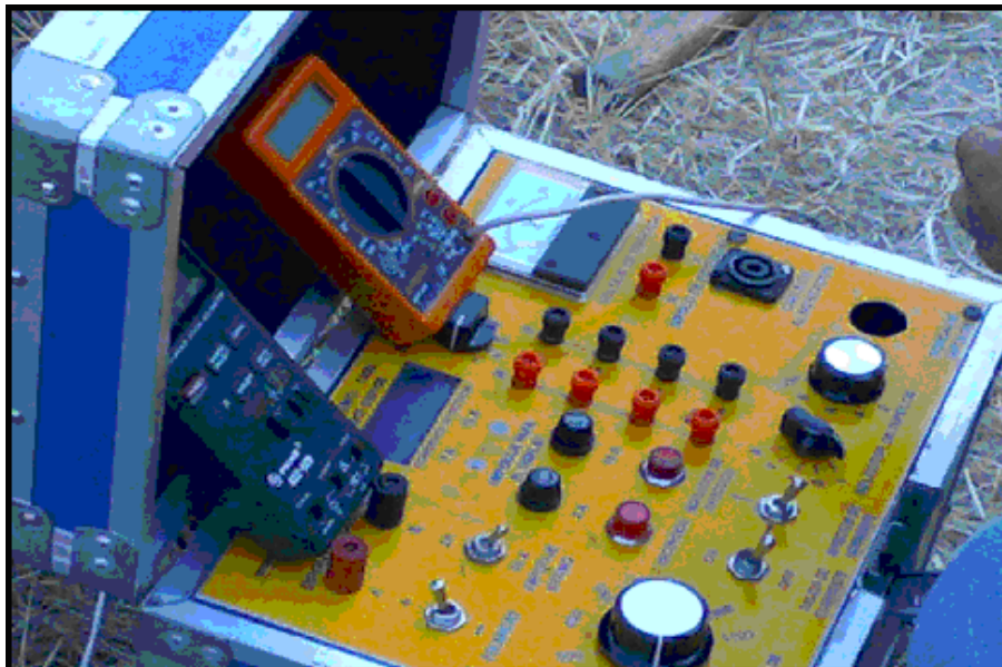
Figura VI Método de Resistividad Eléctrica
