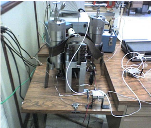
Figura 6.24. Sistema para la medición de la Tensión Interfacial.
