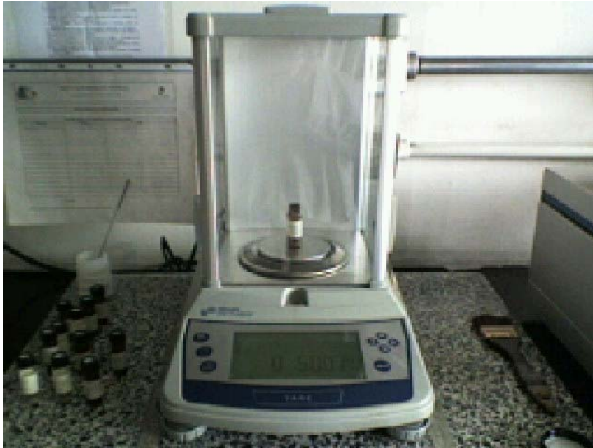
Figura 6.18. Preparación de las muestras requeridas para la determinación de la isoterma de adsorción de surfactante para el mineral del Núcleo No. 1, pozo Ogarrío 1415.
