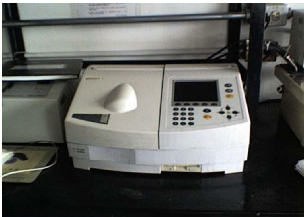
Figura 6.20. Espectrofotómetro UV en donde se mide la longitud de onda de las muestras para la determinación de la isoterma de adsorción de surfactante para el mineral del Núcleo No. 1, pozo Ogarrío 1415.
