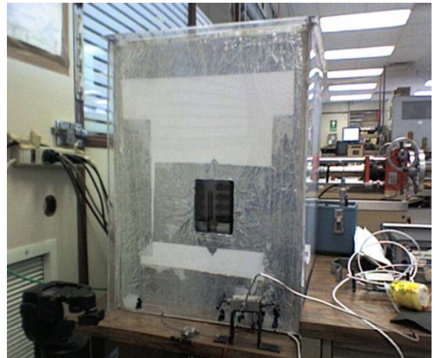
Figura 6.24. Sistema para la medición de la Tensión Interfacial.
