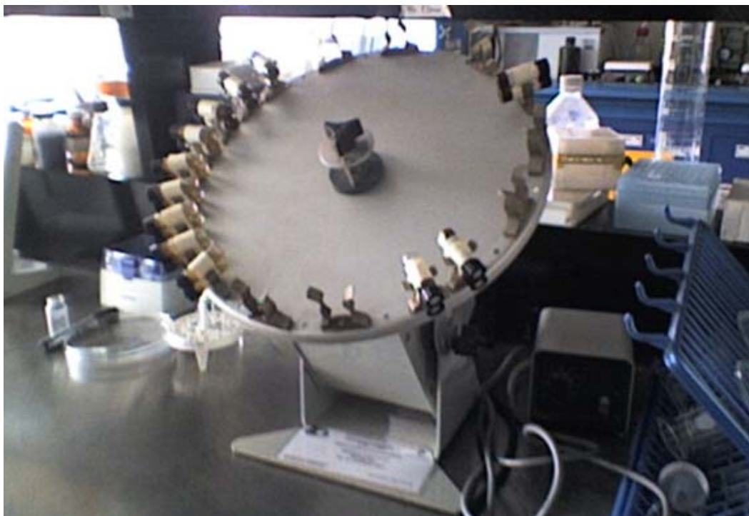
Figura 6.19. Agitación de las muestras por 24 horas para la determinación de la isoterma de adsorción de surfactante para el mineral del Núcleo No. 1, pozo Ogarrío 1415.
