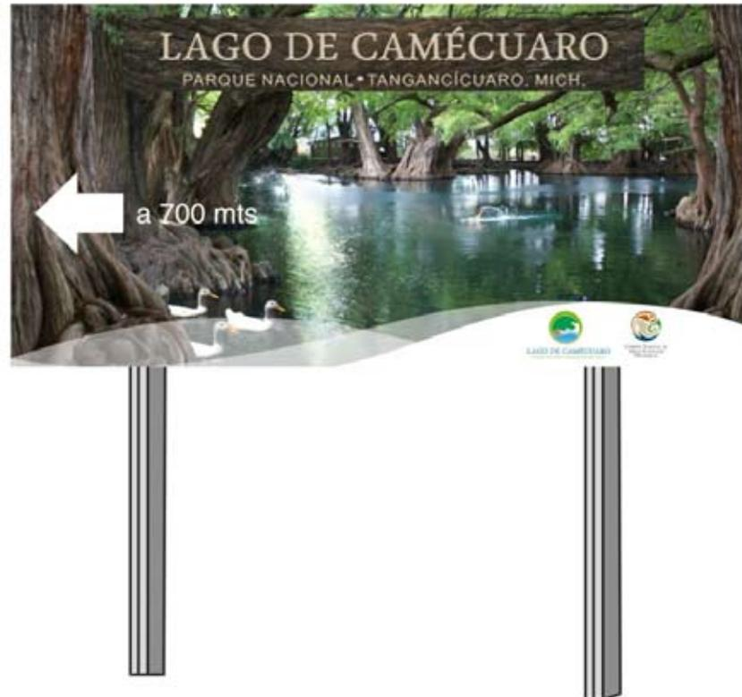
Señal rectangular de metal con lámina galvanizada en tiras de 60 cm. x 3 mts. (tipo SCT) sobre la que se coloca el vinyl autoaherible o lona.
