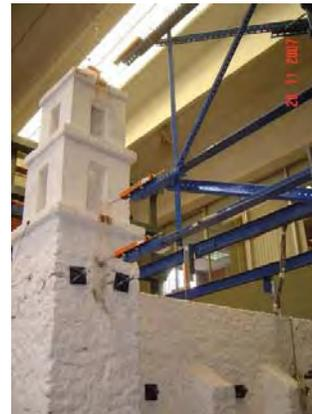
Figura 4.18. Estructuras complementarias para la colocación de los transductores de desplazamiento.
