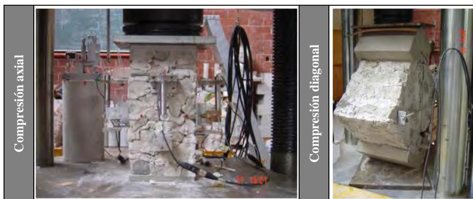
**Figura 3.9.** Ensayes para la obtención de propiedades mecánicas de la mampostería de piedra.
