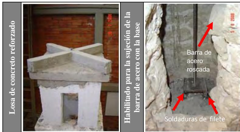
Figura 4.11. Habilitado para la sujeción de la barra de postensado con la base del modelo.
