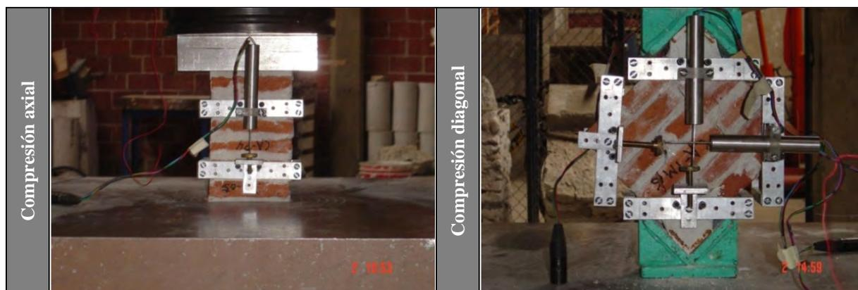
**Figura 3.10.** Ensayes para la obtención de propiedades mecánicas de la mampostería de ladrillo.
