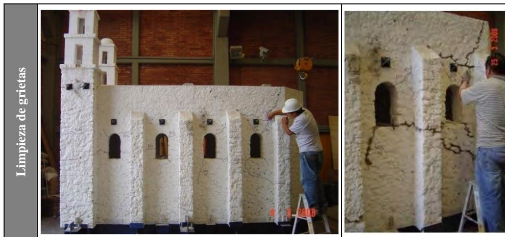
Figura 4.10. Rehabilitación del modelo
