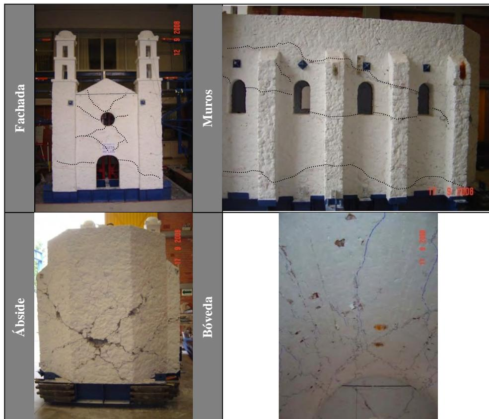
Figura 5.3. Daños del modelo MVTEMP-03 al final del programa experimental
