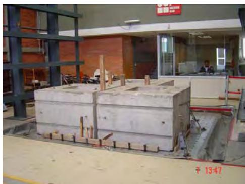
**Figura 4.19.** Lastre utilizado para la calibración de la mesa vibradora
