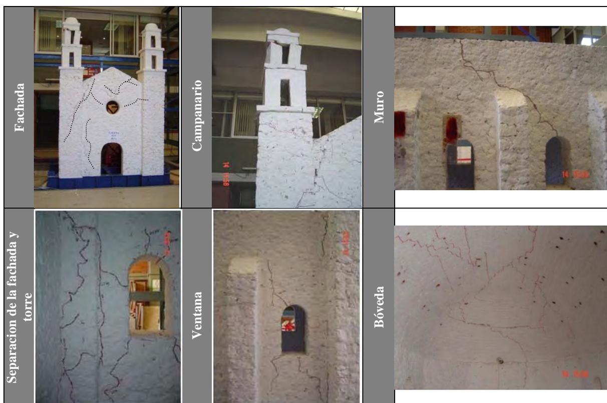
Figura 5.1. Principales daños en el modelo MVTEMP-01.
