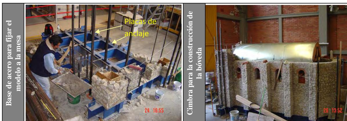
Figura 3.13. Proceso constructivo del modelo
