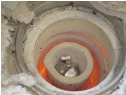
**Figura 20.** Carga dentro de un crisol en un horno de resistencias eléctricas.
