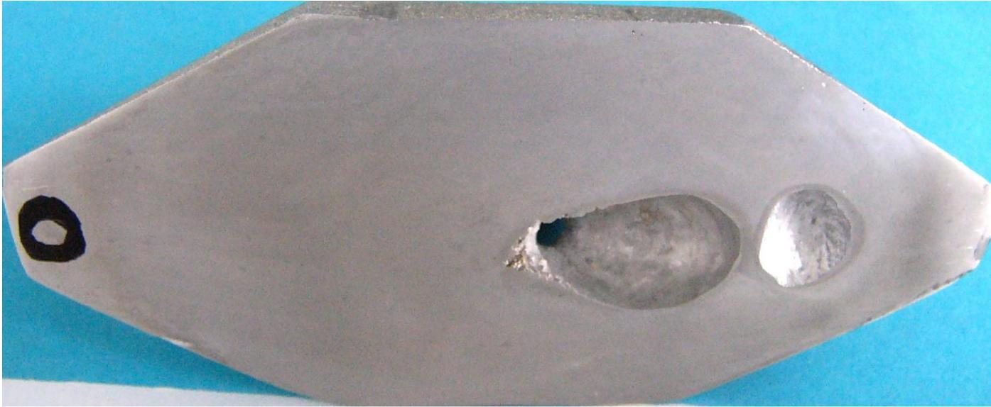
**Figura D1.** Composición Al-0.06%Si, muestra un rechupe localizado.
