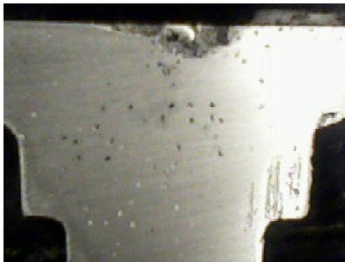
**Figura 10.** Porosidad ocasionada por gases.
