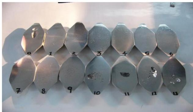
**Figura 28.** Probetas preparadas por metalografía.
