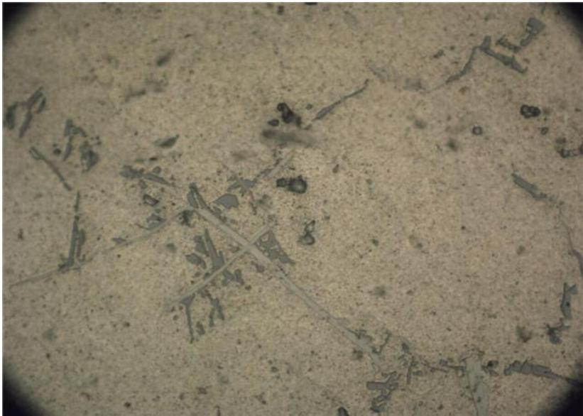
Figura C3. Al – 2.03 Si. Centro probeta **1000X**.
