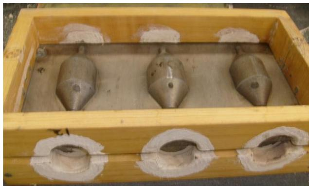
**Figura 21.** Se observa claramente los orificios donde ocurre la colada, por donde entra el metal fundido, hacia cada uno de los tres moldes de geometría z.
