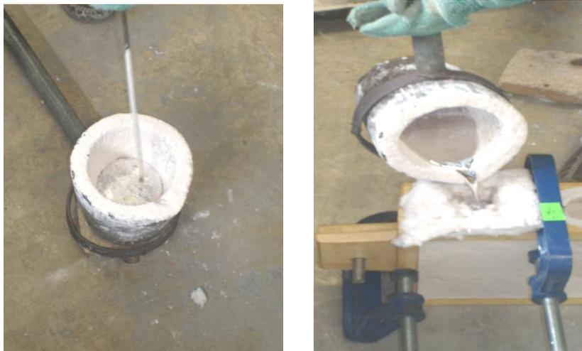
**Figura 26.** Toma de temperatura con termopar y Colada de la aleación en el molde.
