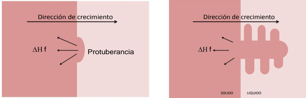
**Figura 3.** Muestra como se forma la protuberancia en la interfase Sólido-Líquido, y como esta va desarrollándose como una dendrita.
