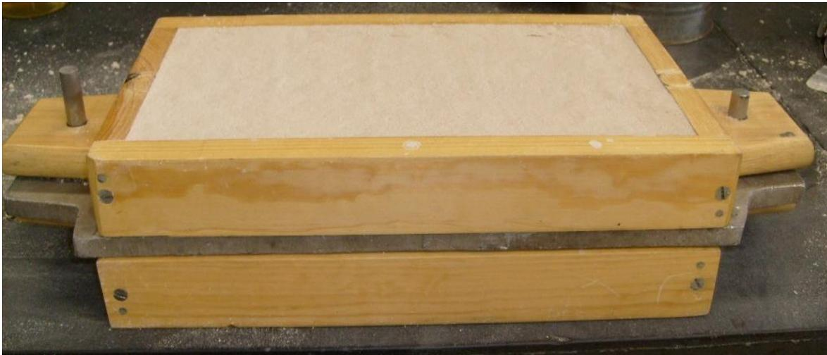
**Figura 23** Moldeo de la arena dentro de la caja de madera.
