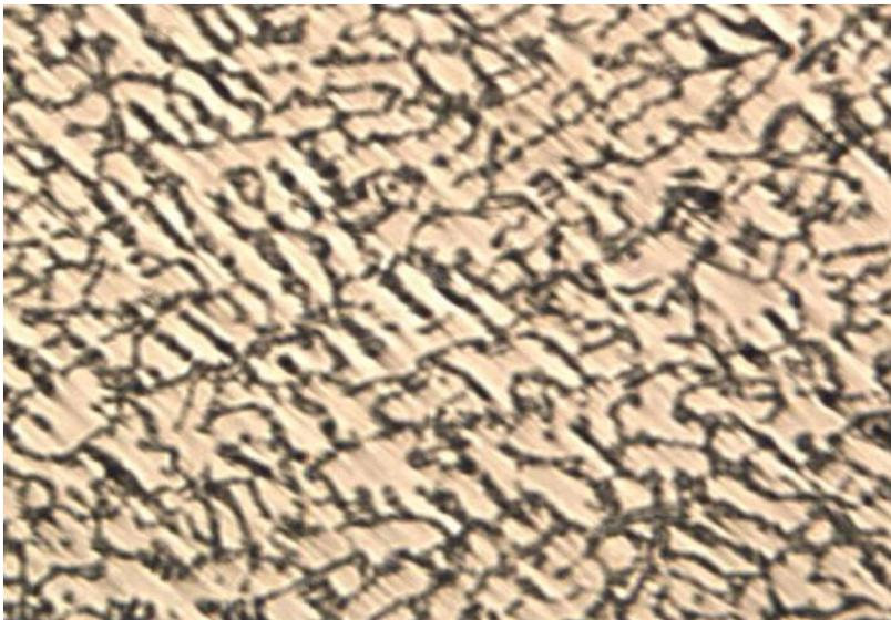
Figura C7. Al – 6.56 Si. Centro probeta **200X**.
