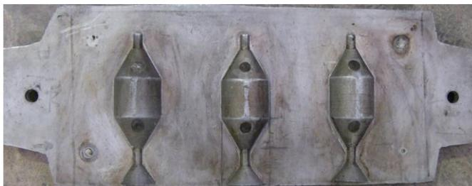
**Figura 19.** Placa modelo con 3 geometrías z de cilindro bi-cono-truncadas.
