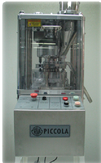
Figura 12. Tableteadora rotativa Piccola Modelo: B10
