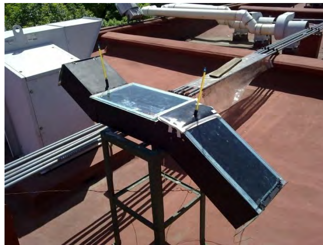
Figura 3.6 Secador con termómetros para hacer lecturas de temperaturas de entrada y salida
