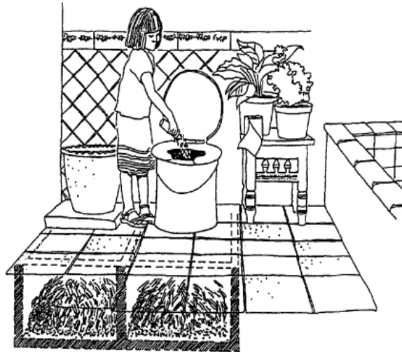
Figura 1.5 La versión mexicana del sanitario vietnamita de doble cámara del cuarto de baño en una casa moderna, donde habita una familia de altos ingresos, en la ciudad de Cuernavaca. Cuenta con una taza de sanitario (de pedestal) móvil con colector de orina. El acceso a las cámaras de tratamiento, debajo del piso del baño, está fuera de la casa.
