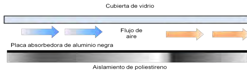
Figura 2.13 Esquema del flujo de aire en el colector solar
