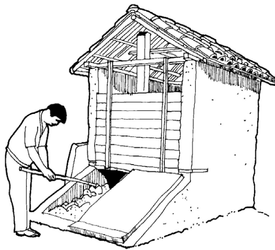
Figura 1.3 Sanitario con doble cámara y calentadores solares en el Ecuador (Esrey et al., 1998)
