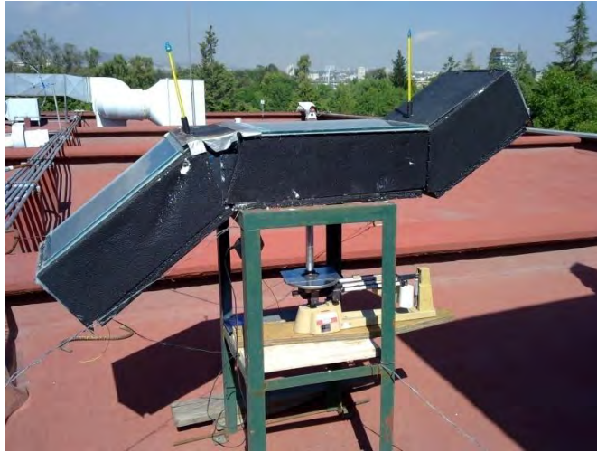
Figura 3.7 Secador terminado con balanza granataria en la base
