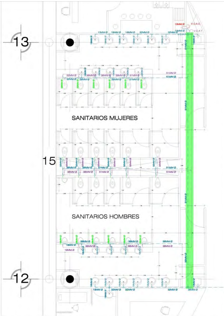
NÚCLEO DE SANITARIOS DE PLANTA BAJA
