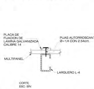
DE-26 FIJACIÓN MULTYPANEL EN LARGUEROS L-4
