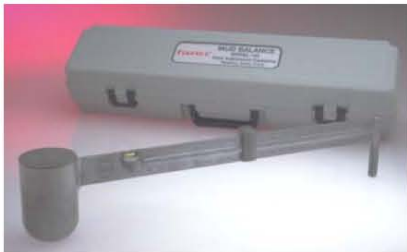
Fig. 1. Balanza de lodos (escala vertical)
