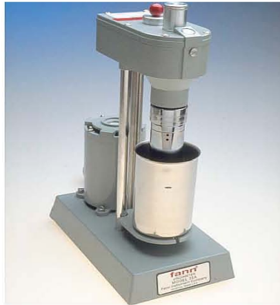
Fig. 4. Viscosímetro de indicación directa típico.
