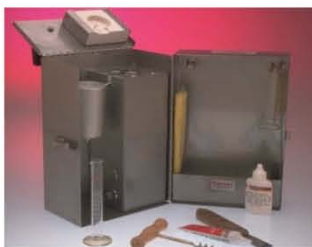
Fig. 7. Retorta para determinar sólidos, aceites y agua.
