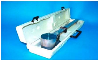
Fig. 2. Balanza de lodos (escala horizontal).
