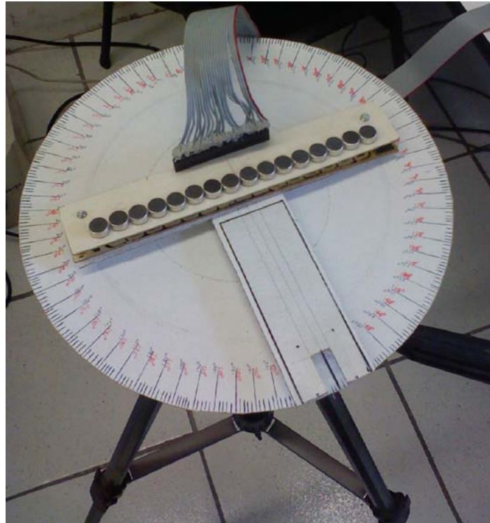
Figura C.6 Arreglo de micrófonos sobre el disco transportador.
