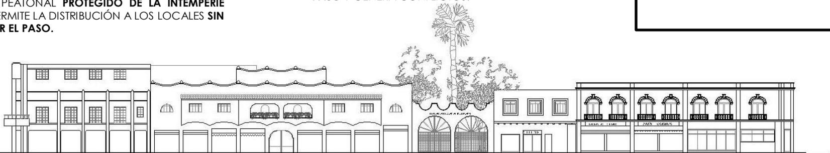
Este edificio se pierde con la escala de Jardín Hidalgo. Tiene un lenguaje simétrico y un ritmo regular en el nivel superior que es totalmente ignorado por la intervención de la planta baja que genera vanos ajustándolos únicamente a su funcionamiento sin ningún cuidado por la composición de la fachada ni por su relación con el exterior.
