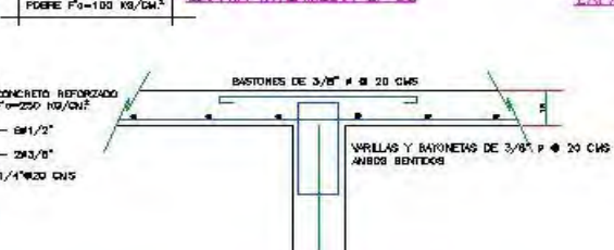
TRASLAPE DE LOSAS Y TRABES
