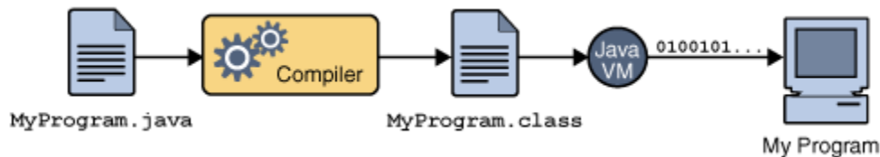
Figura 4. Esquema de compilación de un archivo .java y generación del .class[25].
