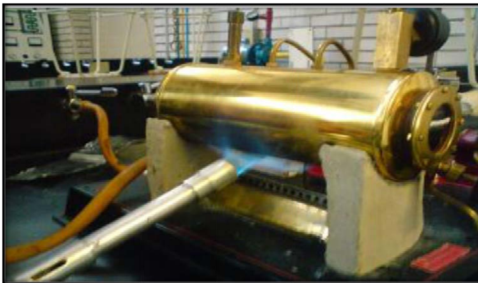
Figura IV.19: Calentamiento mediante mechero Bunsen
