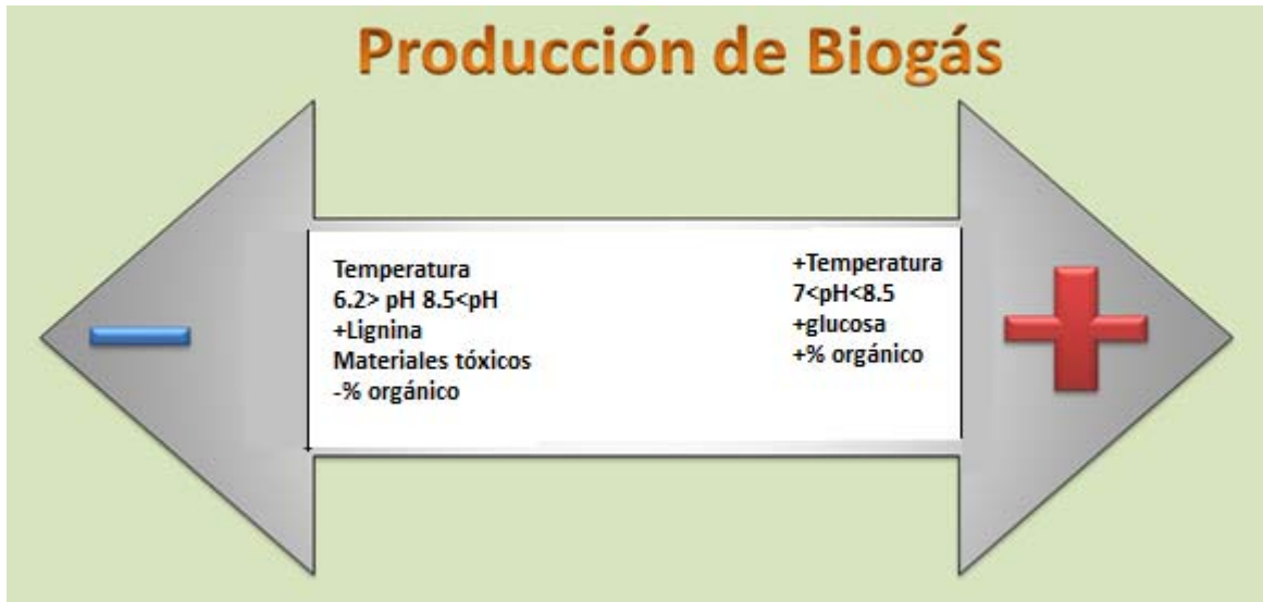
Figura II.32: Síntesis del efecto de los parámetros físico químicos sobre la producción de biogás (realizada a partir de Goswami y Kreith, 2008)
